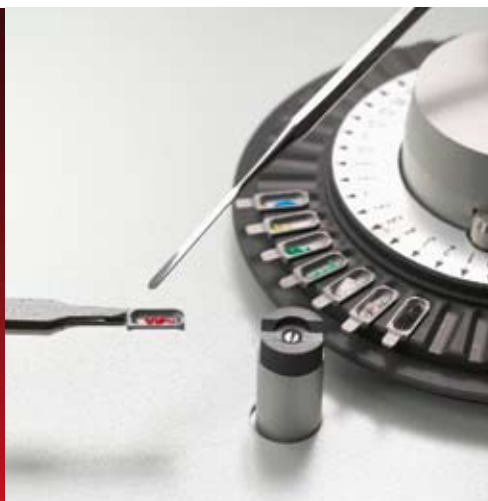
♥ Встроенные в SSA 600 микровесы
