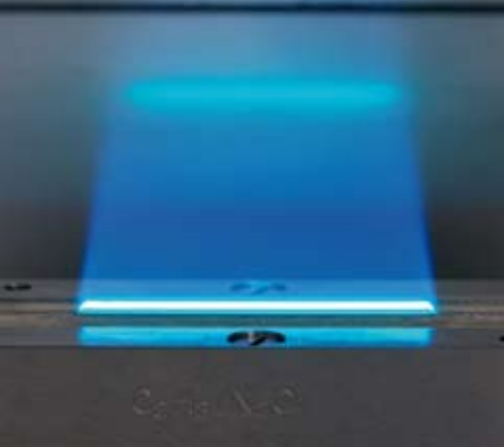
▲ Горелка для пламени ацетилен-закись азота
