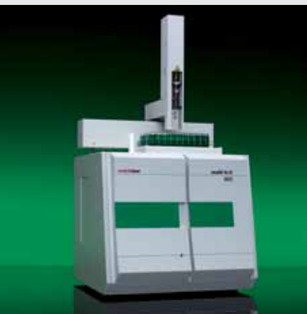
◀ multi N/C® 2100 – определение TOC/TN b в питьевых/природных/сточных водах
