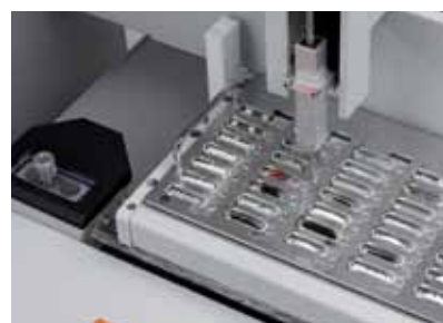
▲ Универсальный автодозатор MMS 5000 для ввода жидких и твёрдых проб в горизонтальном и вертикальном режимах
