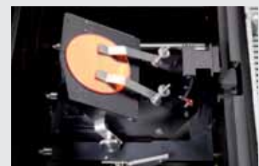
▲ Приставка для для определения толщины пленок и покрытий
