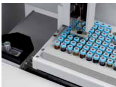
▲ Универсальный автодозатор MMS 5000 для ввода жидких и твёрдых проб в горизонтальном и вертикальном режимах
