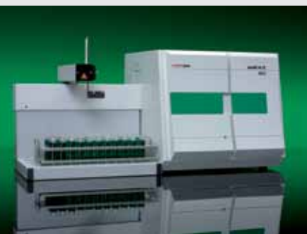
◀ multi N/C® 3100 – универсальный анализатор для определения TOC в широком диапазоне концентраций в различных типах вод. Позволяет решать разнообразные задачи полупроводниковой/энергетической промышленности и проводить экологический мониторинг.
