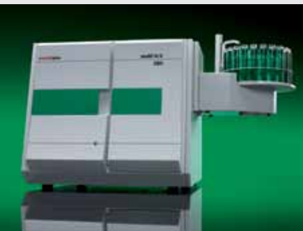
◀ multi N/C® UV HS: разложение проб методом „мокрой химии“ под действием жесткого УФ-излучения с добавлением персульфата калия (при необходимости). В таких реакторах отсутствуют подверженные износу компоненты, что существенно снижает стоимость обслуживания прибора.
