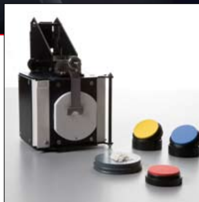
Интегрированная сфера для определения коэффициента пропускания и измерения диффузного отражения
