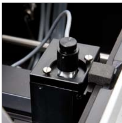
Держатель кюветы, термостатируемый элементом Пельтье гарантирует точность установки температуры. Температура измеряется непосредственно в кювете.
