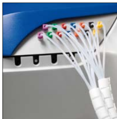
SPECORD® PLUS совместно с тест-системой позволяют определять степень высвобождения активных ингредиентов в ходе растворения лекарственного препарата
