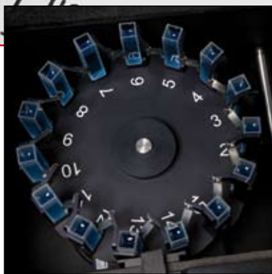
Вместительное кюветное отделение позволяет устанавливать как одно-позиционные держатели кювет, так и 15-позиционную карусель в зависимости от задачи
