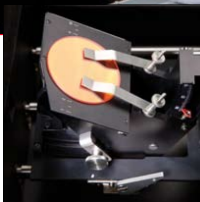
Приставки для определения абсолютного коэффициента отражения с изменяемым углом преломления луча для определения показателя преломления и толщины плёнки
