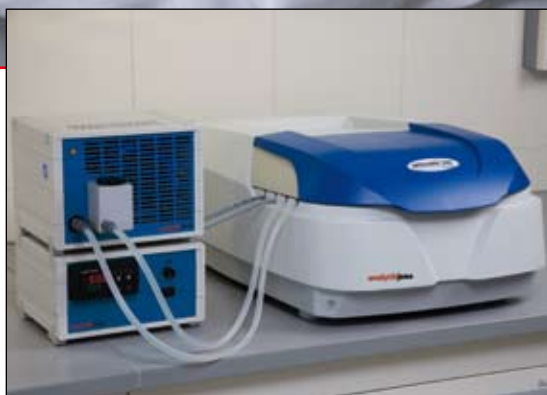
8-позиционный кюветодержатель, термостатируемый элементом Пельтье, для проведения измерений, чувствительных к изменению температуры
