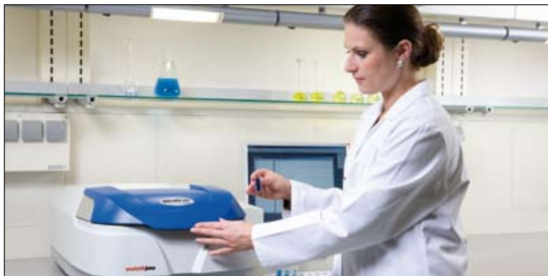
Вместительное кюветное отделение позволяет устанавливать как одно-позиционные держатели кювет, так и 15-позиционную карусель в зависимости от задачи
