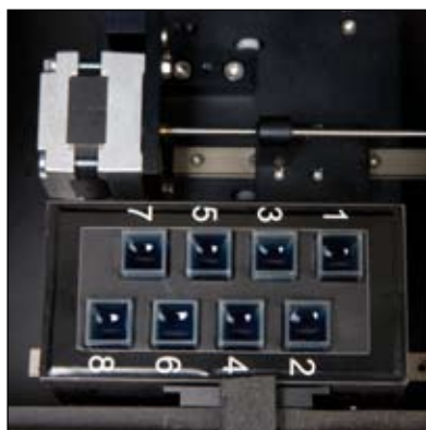
8-позиционное устройство смены кювет
