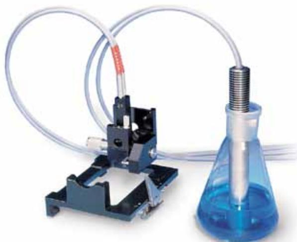
Погружной зонд и оптоволоконное устройство
